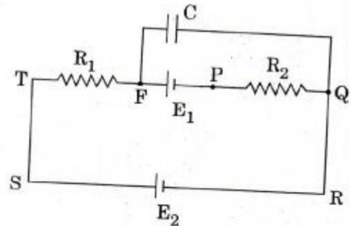
यहाँ दिए गए परिपथ में,  $C = 2 \mu F$ ,  $R_1 = 3 \Omega$ ,  $R_2 = 5 \Omega$ ,  $E_1 = 12 V$ ,  $E_2 = 16 V$ .
